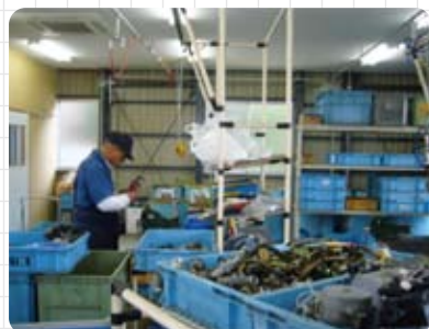
使用済み給湯器の分解・分別作業を行う様子
